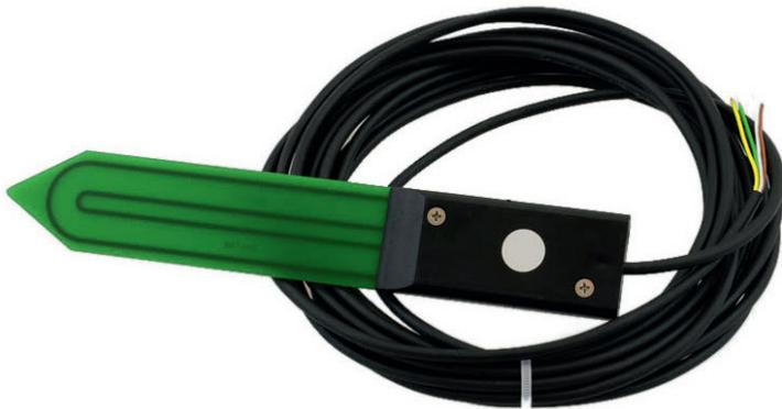
Ein Feuchtfühler gibt das Signal zur Unterbrechung der Bewässerung immer dann, wenn kein Wasserbedarf bei den Pflanzen besteht. | Foto: Aqua-Technik
